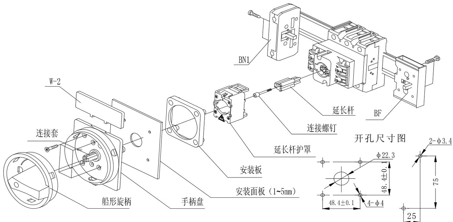
安装步骤：门护锁导轨安装采用 TH35-7.5 型导轨：
